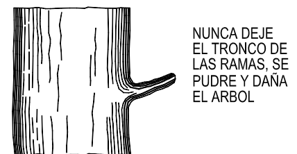
d) CORTE INCORRECTO
